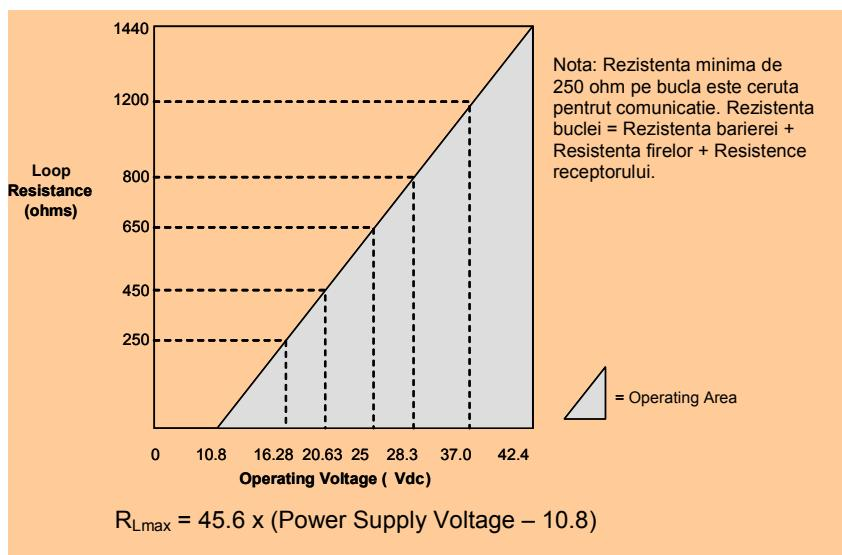
Figura 2 – Tensiunea de alimentare si diagrama de calcul a rezistentei de buclă
